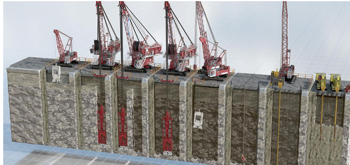
ILUSTRACIÓN 1 - ESQUEMA GENERAL DE EJECUCIÓN DE MUROS PANTALLA (FUENTE: SOLETANCHE BACHY)
